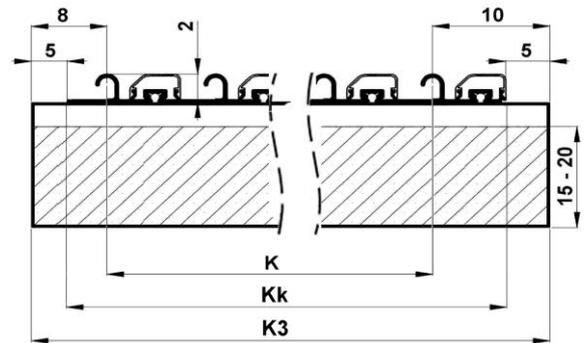
Breite der Schienen (K) entspricht dem multipliziert Achsabstand der Schienen (7 cm)
