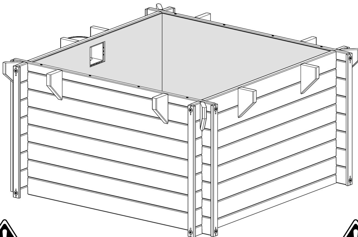
Der wichtigste Bestandteil des Beckens ist die Folienauskleidung. Schwimmbadfolie ist ein thermoplastisches Material, das sich unter Einwirkung von Wärme ausdehnt bzw. bei Kälte zusammenzieht.
