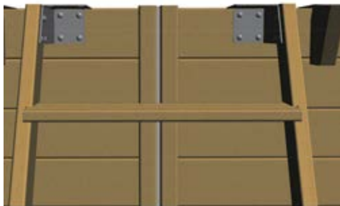
Abbildung 18 – Anbringen der Außentreppe am Becken
