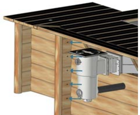
Abbildung 64 – Befestigung des Motorschachts am Pool
