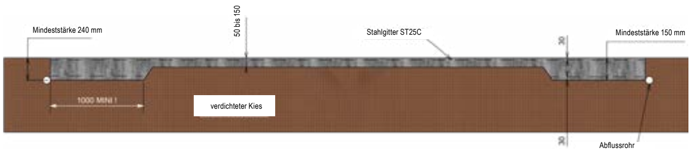
Abbildung 1 – Grenze des Aushubs und Abmessungen der Betonplatte
