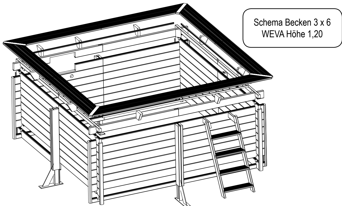
Abbildung 66 – Schema Becken 3 x 6 WEVA Höhe 1,20
