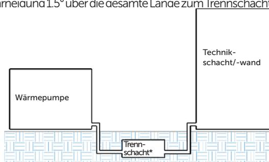
\* Wenn die gesamte Länge der Rohrleitung zur Filteranlage hin geneigt ist, ist kein Trennschacht erforderlich.
