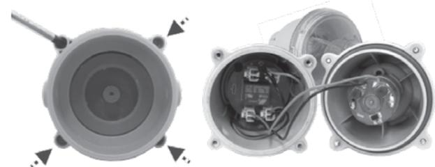
3. Drehen Sie die beiden Schrauben wie abgebildet heraus, um das Modul zu lösen. Bewegen Sie es zur Öffnung der Kammer.
