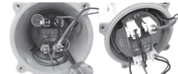
4. Lösen Sie alle 4 Kabelstecker, indem Sie auf den Clip drücken und dabei den Stecker abziehen. Entfernen Sie das gesamte Modul aus der Kammer, um die Batterie freizulegen. Entfernen Sie die Batterie und wickeln Sie Isolierband um das Steckerende, um einen Kurzschluss durch den Kontakt beider Drahtklemmen zu vermeiden.
