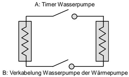
Hinweis: Der Installateur sollte A parallel zu B (wie oben Bild) verbinden. Um die Wasserpumpe zu starten, ist es wichtig, dass A oder B verbunden sind. Um die Wasserpumpe zu stoppen, müssen sowohl A als auch B getrennt werden.
