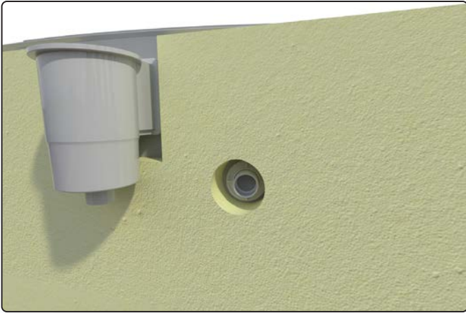
Einbauteile ausschneiden ausschneiden
